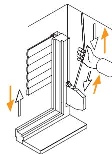
**Ouverture/fermeture avec une manivelle**
