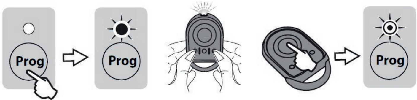
L'émetteur dispose de 4 canaux, veillez à sélectionner le bon canal lors du deuxième appui sur l'émetteur (les émetteurs présents dans le kit sont déjà mémorisés).
