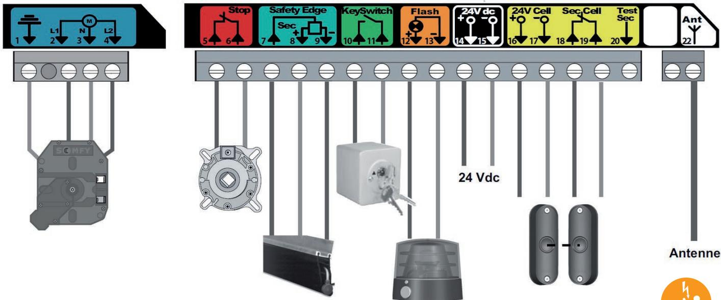
**Si pas de cellule, pont sur bornes 18 et 19 !**
