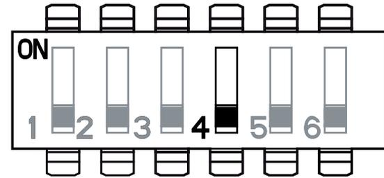
**Fonction test de la barre palpeuse : mettre en place la résistance sur bornes 7 et 8**
