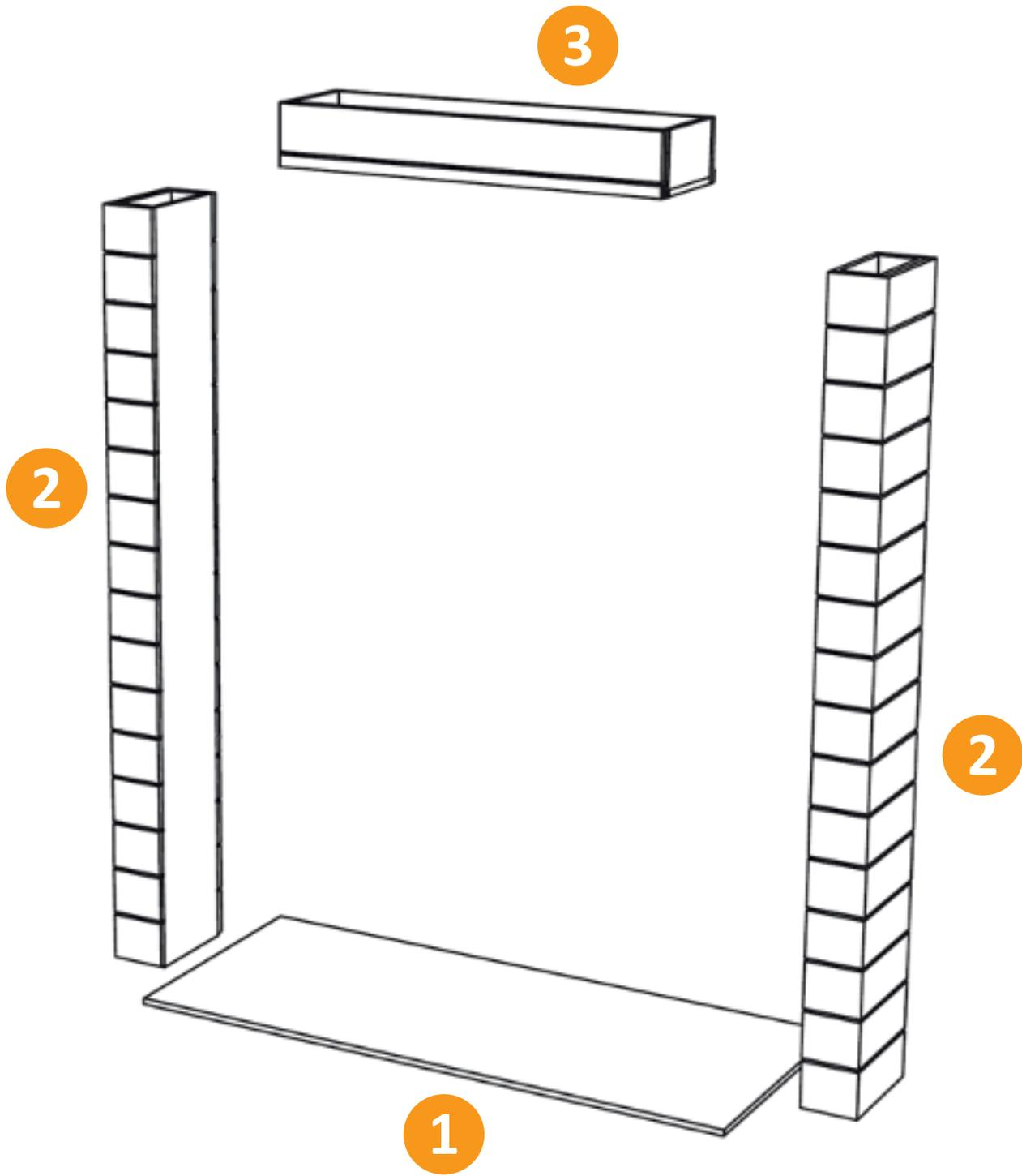
**Grundplatte (1) am geplanten Standort platzieren und Sockel positionieren
