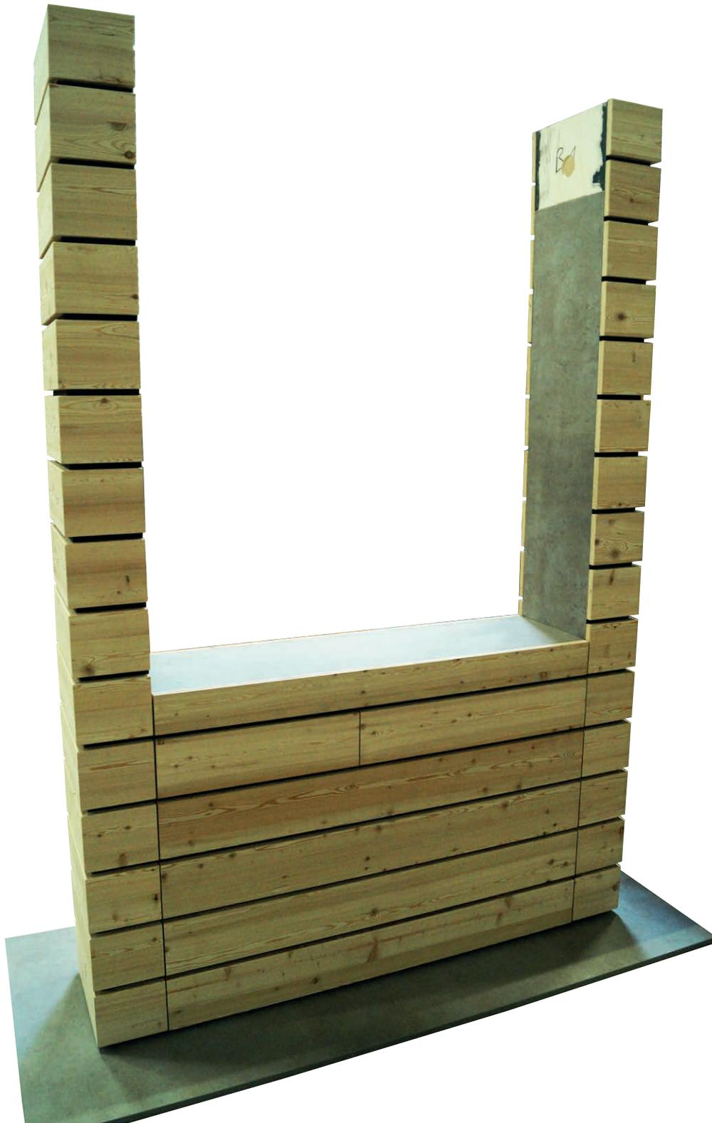
Mettre le linteau en place (prendre garde à ce que les ouvertures, servant au passage de câbles, présentes sur le linteau et l'un des poteaux correspondent).
