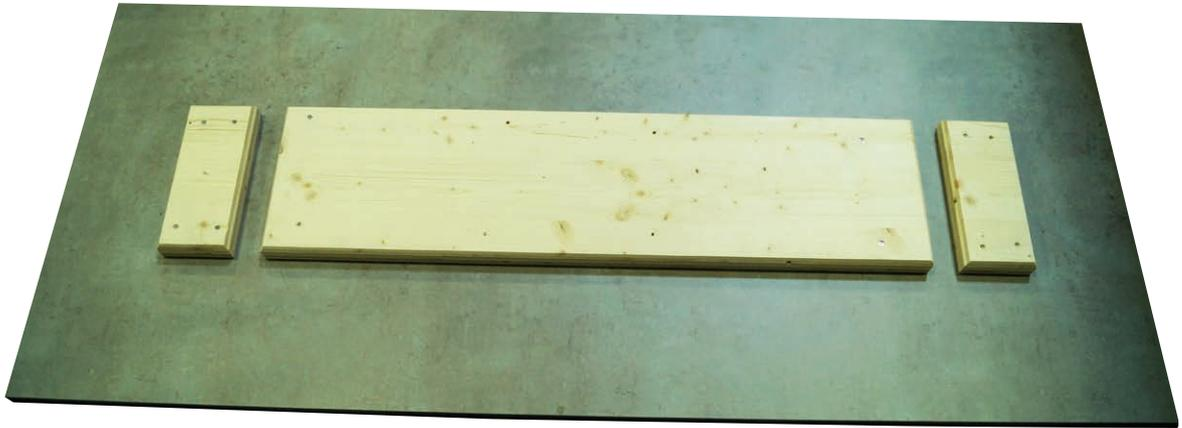
**Mettre en place la partie centrale (2) sur le sabot central et la centrer par rapport aux sabots accueillant les jambages**
