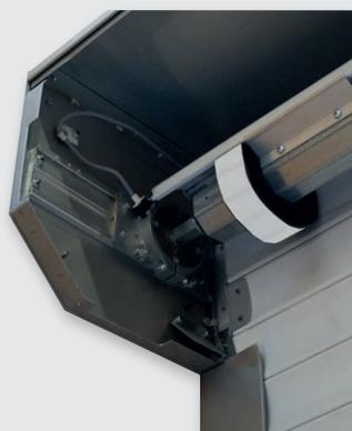
Nos portes disposent toutes de tabliers agrafés pour un fonctionnement pérenne et, selon le modèle, peuvent être équipés d'un palier mobile. La liaison avec l'axe se fait via des verrous en aluminium extrudés. Une feutrine sur les bagues d'axe vient protéger les lames de la porte contre les frottements.
