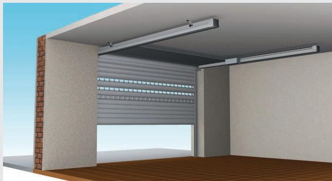
La porte ALTO S se loge à plat sous le plafond du garage. Elle permet une pose avec une faible retombée de linteau. 5 cm seulement sont nécessaires pour une porte motorisée. La lame finale peut être totalement dégagée libérant ainsi toute l'ouverture de passage.
