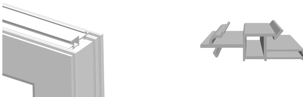
En raison de la plage de tolérances du support du dormant, la force de maintien de l'adaptateur peut varier. Si ce dernier est trop lâche, il doit être à nouveau fixé en effectuant un vissage supplémentaire. Il n'est pas nécessaire d'ajouter une bande comprimée entre les cavités.
