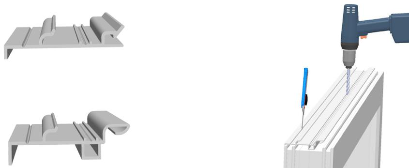
Renforcer l'étanchéité de l'adaptateur universel à l'aide d'un matériau d'étanchéité adéquat. En cas d'appui sur toute la surface, appliquer un matériau d'étanchéité injectable entre le dormant et l'adaptateur. Pour les profils de fenêtre ayant une cavité sous l'adaptateur, étanchéfier cette dernière à l'aide d'une bande comprimée. Les bandes comprimées doivent mesurer exclusivement 10 mm de largeur pour une largeur de joint de 2 à 4 mm.
