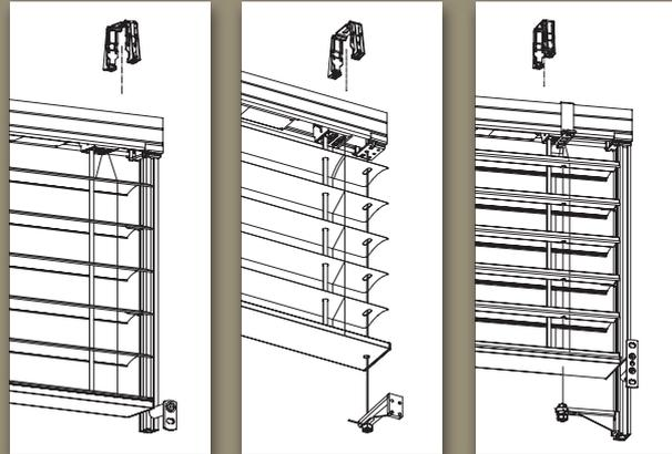
Le guidage du tablier (montée-descente) peut se faire par câbles, par coulisses ou encore par combinaison de ces 2 systèmes.
