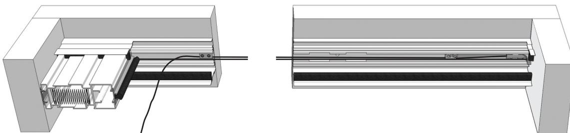
Nouer le cordon avant le tendeur à l'aide d'un triple nœud coulant et le serrer bien fort. Couper ensuite le reste du cordon d'environ 3 cm après le nœud.
