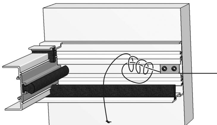
Tendre légèrement le cordon à l'aide du tendeur de cordon tel qu'indiqué dans l'étape **3 8** et serrer les tiges filetées.
