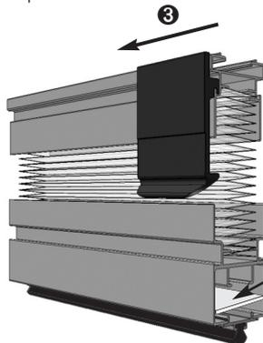
Insérer la fermeture du modèle plissé dans le profilé sans les brosses par le haut ③, la glisser jusqu'au milieu et fermer la toile plissée. Tirer le cordon avec le renvoi et le tendeur de cordon à l'extérieur du modèle plissé à l'aide de la bande en carton ④.
