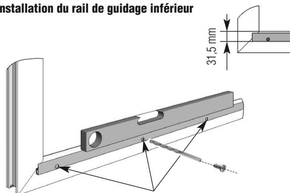
Prépercer les trous de montage et fixer le rail de guidage avec les vis RK 3,5 x 13.
