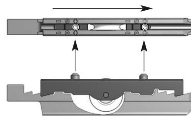
Correction maximale de 2 mm (un côté vers le bas et l'autre vers le haut).
