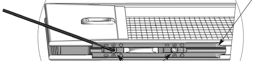
Desserrer les vis à l'aide de la clé Allen de 2,5 mm et déplacer le support à galet en plastique dans la direction souhaitée. Puis resserrer les vis.
