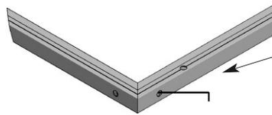
Serrer alternativement à gauche et à droite avec la clé Allen.
