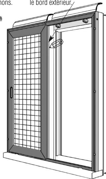
5 Retirer le vantail coulissant. Prépercer les trous de montage du profilé central et fixer avec les vis SK 3,9 x 38
