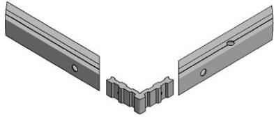
Assembler les profilés supérieurs et latéraux avec les équerres pour former un cadre en U.
