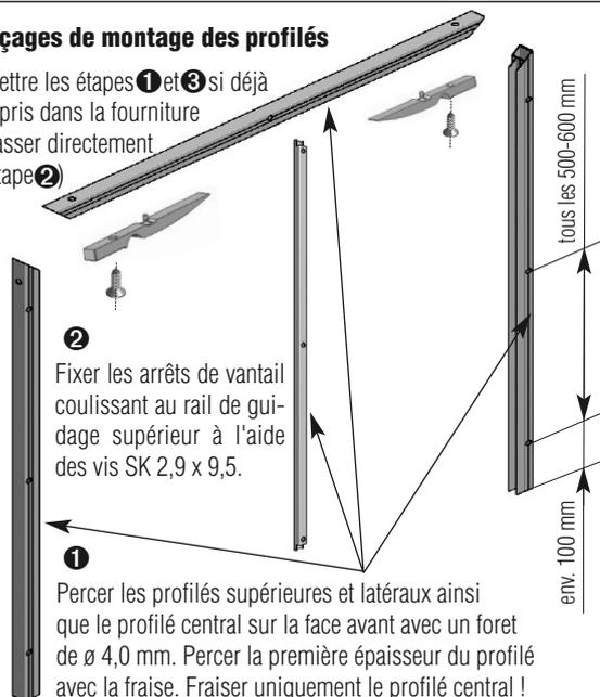
2 Fixer les arrêts de vantail coulissant au rail de guidage supérieur à l'aide des vis SK 2,9 x 9,5.
