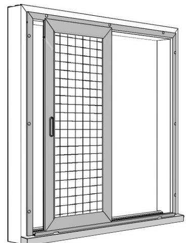
Le rail de guidage du vantail coulissant (partie inférieure) peut être entièrement soulevé sur le côté opposé, ce qui permet d'assurer la sécurité anti-dégondage et de prévenir tout basculement lorsque les vantaux présentent de très petites dimensions.
