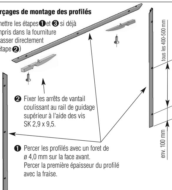
② Fixer les arrêts de vantail coulissant au rail de guidage supérieur à l'aide des vis SK 2,9 x 9,5.
