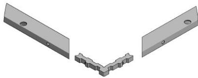
Assembler les profilés supérieurs et latéraux avec les équerres pour former un cadre en U.
