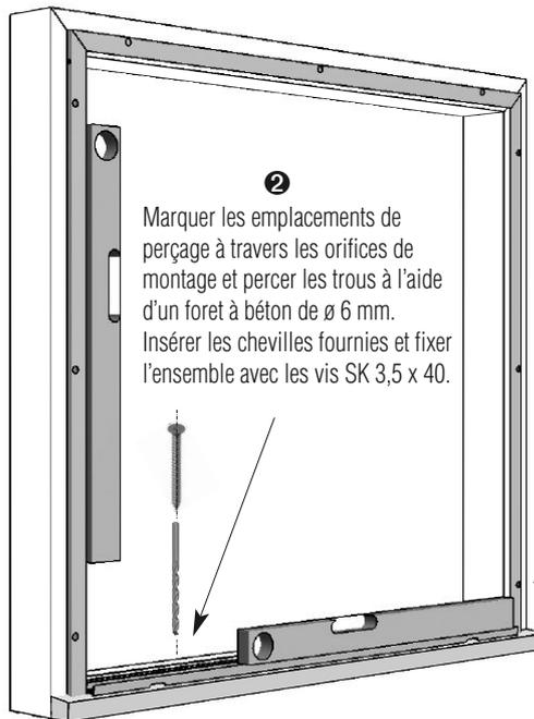
2 Marquer les emplacements de perçage à travers les orifices de montage et percer les trous à l'aide d'un foret à béton de  $\varnothing$  6 mm. Insérer les chevilles fournies et fixer l'ensemble avec les vis SK 3,5 x 40.
