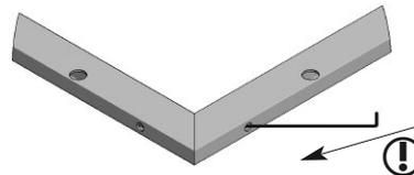
Serrer alternativement à gauche et à droite avec la clé Allen de 2,0 mm.
