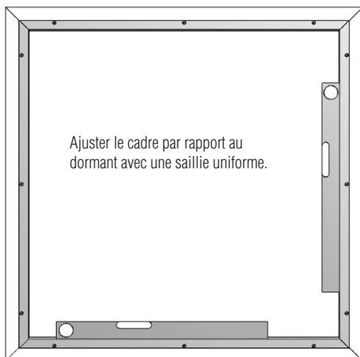
Prépercer les trous de montage et fixer le cadre avec les vis RK 3,5 x 13. Placer les capuchons..
