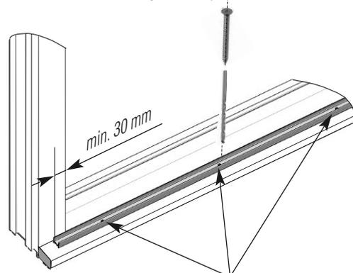
Marquer les emplacements de perçage à travers les orifices de montage et percer les trous à l'aide d'un foret à béton de ø 6 mm. Insérer les chevilles fournies et fixer le rail de guidage avec les vis SK 3,5 x 40.
