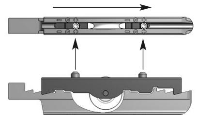
Correction maximale de 2 mm (un côté vers le bas et l'autre vers le haut).
