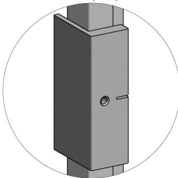
Placer le gabarit de perçage (P16 40 10) selon les mesures indiquées. Percer les coulisses de guidage par l'avant avec un foret de ø 4,5 mm. Percer la première épaisseur du profilé avec la fraise.
