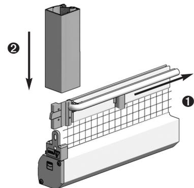
Actionner la fermeture de la moustiquaire enroulable et la maintenir ①. Enfoncer les coulisses de guidage jusqu'à la butée ②.
