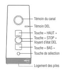
Pour pouvoir commander d'autres moteurs avec la même télécommande multicanaux, sélectionner le canal à programmer pour l'élément choisi et procéder tel qu'indiqué à partir du point **5**.
