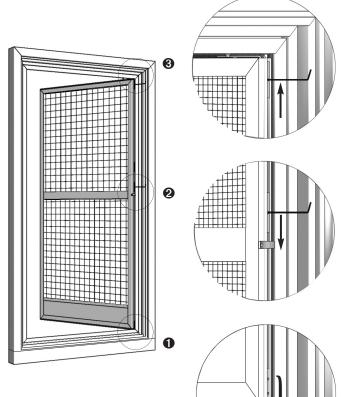
① Insérer le cadre pivotant tel qu'illustré dans la figure en glissant le tenon inférieur dans la mortaise, ② ajuster à la charnière du milieu, pousser la pièce de serrage dans la charnière et la serrer avec la clé Allen fournie avec la moustiquaire. ③ Insérer la charnière du haut au maximum dans la mortaise avec la clé Allen fournie avec la moustiquaire et la serrer à fond.
