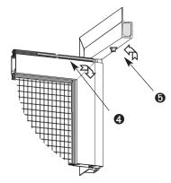
Vérifier que la distance du cadre pivotant par rapport au cadre de montage est la même sur tout le tour (6 mm). Si nécessaire, ajuster le cadre de montage.
