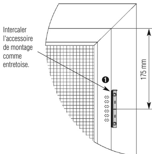
**1** Intercaler l'accessoire de montage comme entretoise entre le corps de la fermeture aimantée et le cadre pivotant. Les aimants du corps et du cadre pivotant entrent en contact. Positionner le centre du corps de la fermeture aimantée à 175 mm du bord extérieur du cadre pivotant.
