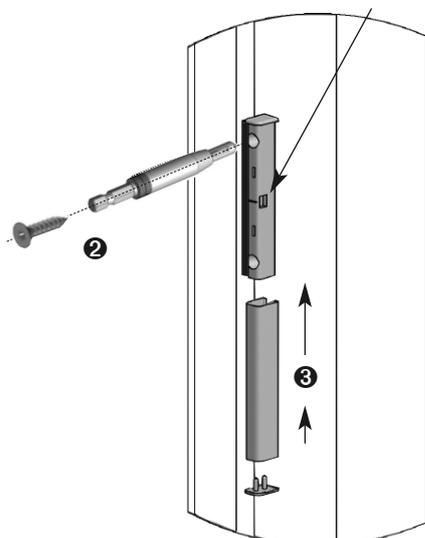
**2** Percer un avant-trou avec le foret à centrer et fixer à l'aide des vis de montage à tête fraisée 3,5x16.
