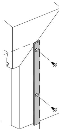
**Attention :** des vis mal serrées et en saillie empêchent la bande magnétique d'adhérer convenablement.
