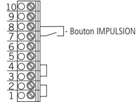
**Contacteur à clé OUVERTURE / FERMETURE**
