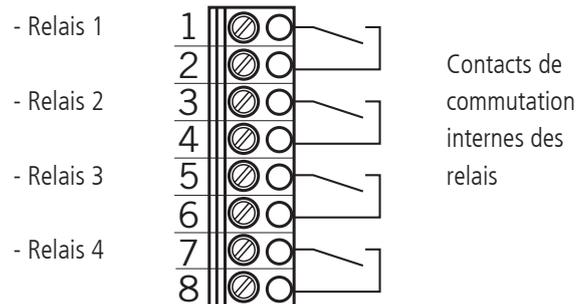
Il s'agit de quatre sorties relais sans potentiel avec une charge maximale de 4A pour 230 V/1~.
