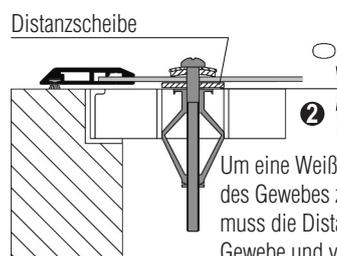
Um eine Weißverfärbung des Gewebes zu vermeiden muss die Distanzscheibe zwischen V2A-Gewebe und verzinktem Gitterrost montiert werden.
