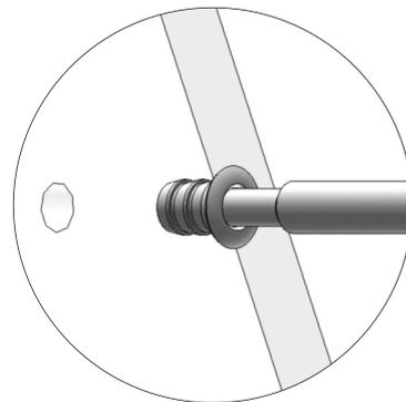
**!** Abhängig vom Untergrund kann die rechtwinkelige Lage der Hülse zur Leibung mit Hilfe des Hülseneinschlags leicht korrigiert werden.
