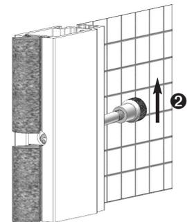
Schieberahmen zur Maßkontrolle in der Leibung in Einbauposition stellen und Position der Auflagerundeile festlegen und markieren.
