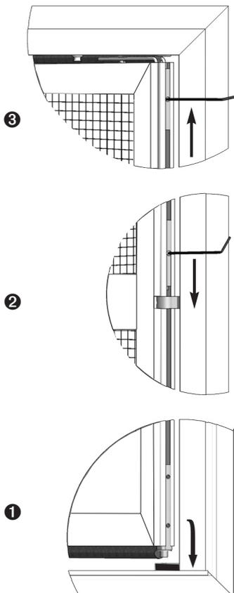
❶ Drehrahmen wie abgebildet mit dem unteren Drehbeschlag in das Aufnahmeteil stecken, ❷ zum Mittelband ausrichten, Schiebeklemmteil mit dem mitgelieferten Inbusschlüssel in das Mittelband schieben und anziehen. ❸ Oberen Drehbeschlag mit dem mitgelieferten Inbusschlüssel auf Anschlag in Buchse einschieben und fest anziehen.
