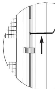
Drehrahmen nach vorne kippen und herausheben. Bürstendichtungen aus dem Montagerahmen entfernen.
