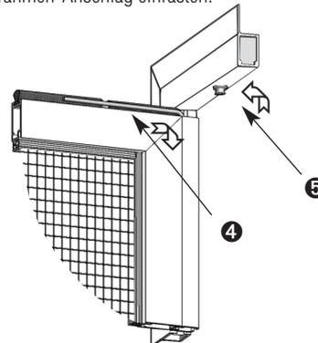
Den Abstand des Drehrahmens zum Montagerahmen prüfen, ob dieser seitlich und oben gleich ist (6 mm), bei Bedarf die Position des Montagerahmens korrigieren.
