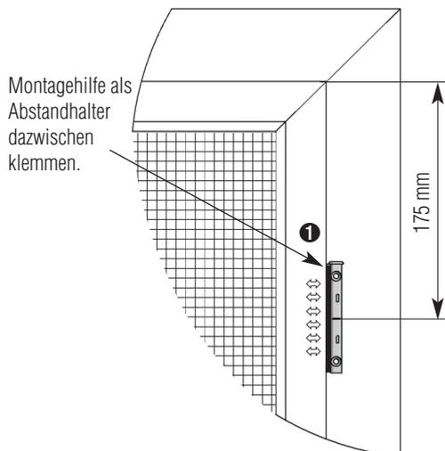
**1** Montagehilfe als Abstandhalter zwischen Magnetschließersatz-Grundkörper und Drehrahmen klemmen. Die Magnete aus dem Grundkörper und Drehrahmen fangen sich. Mitte Magnetschließersatz-Grundkörper 175 mm von Außenkante Drehrahmen positionieren.
