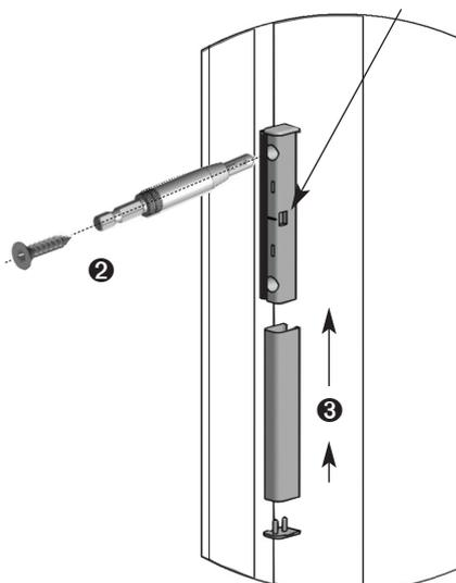
**2** Mit dem Zentrierbohrer vorbohren und mit Montageschrauben SK 3,5x16 anschrauben.
