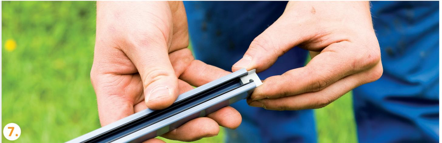
Nun die Endstopen in die Führungsschienen drücken und bündig unten festschrauben.
