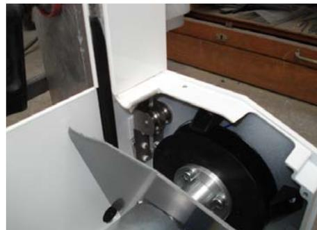
7. Seil durch vorgegebene Bohrung in der Seilscheibe ziehen und am Ende verknoten.
