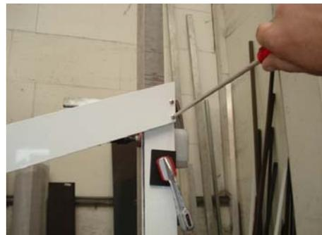
10. Panzer unter der Welle durchschieben und das Seil durch das vorgegebene Loch ziehen und neu verknoten
